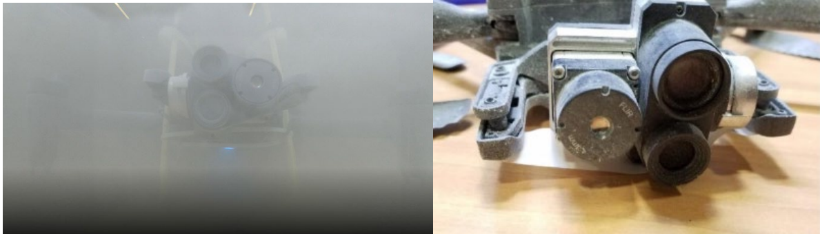
Fig. 7 : Tests IP5X (sable)
