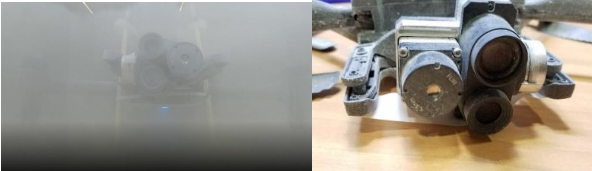
Fig. 7: IP5X test (sand)
