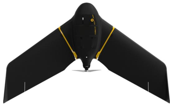
**L'eBee Plus** est un drone de cartographie photogrammétrique à grande couverture doté d'une évolutivité RTK / PPK, pour une haute précision. Les capteurs proposés sur l'eBee Plus conviennent à une très large gamme d'applications géospatiales, les capteurs thermiques infrarouges et multispectraux.
