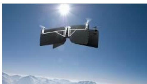
La forme en X de **Swing** lui permet de **voler à la fois horizontalement et verticalement**.
